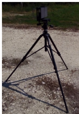
Сл. 2 – Доплер радар EDH модел ED2605R
