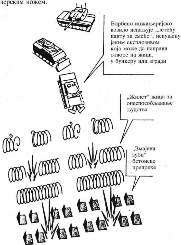
Шема 3: Употреба борбених возила инжењерије за израду пролаза кроз сложенији систем препрека
