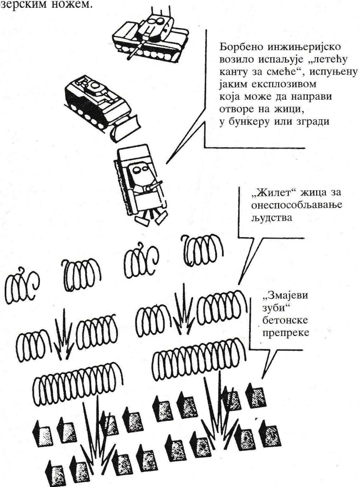
Шема 3: Употреба борбених возила инжињерије за израду пролаза кроз сложенији систем препрека
