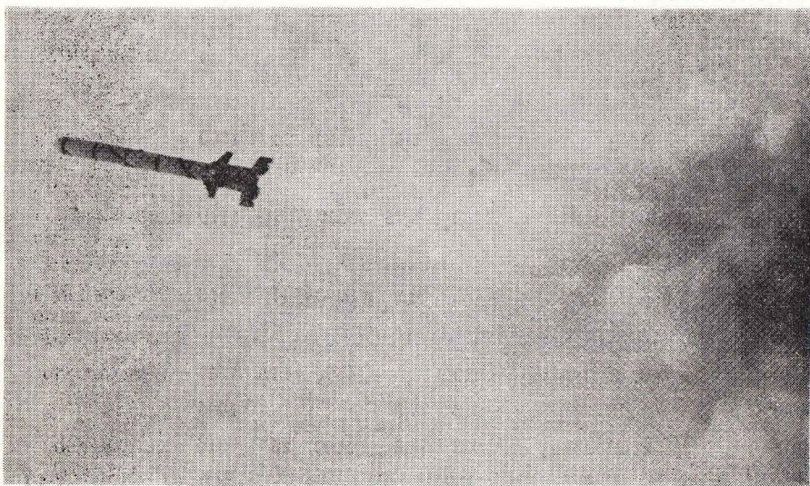
Slika 2 — Eksperimentalno lansiranje krilate rakete »Harpoon« iz podvodne vožnje; raketa ima domet od oko 30 milja i aktivni radarski sistem samonavođenja
