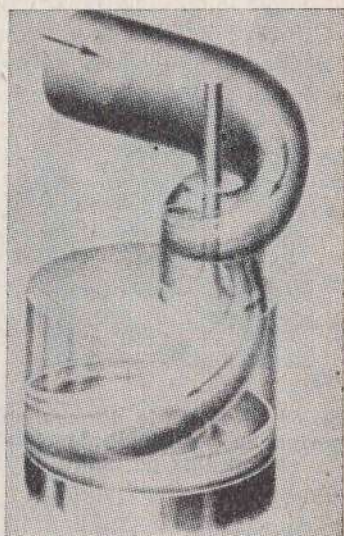
Sl. 68 — Usmereno usisavanje vazduha po »M« postupku
