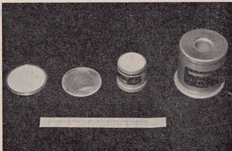
Sl. 18 — Scintilatori. S leva na desno: cink-sulfid na staklu, plastični scintilator, natrijum-jodid sa rupom i natrijum-jodid bez rupe
