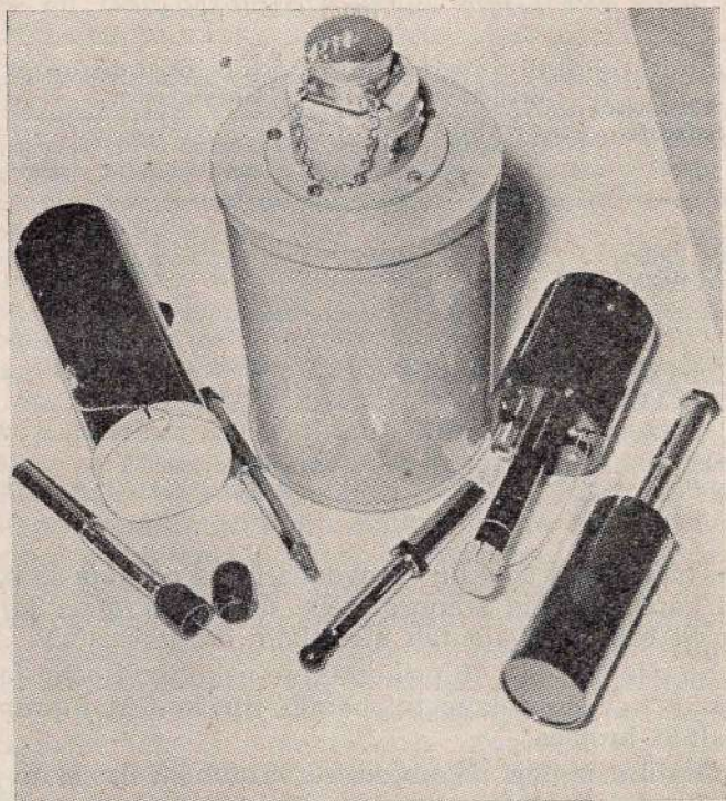
Sl. 14 — Jonizacione komore. Četiri od njih imaju metalne nosače. U prednjem planu jedna je rasklopljena pa se vidi anoda u centru
