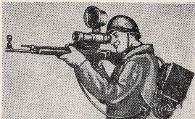
Sl. 67 — nišanski IC-uređaj za automat, dometa do 70 m, poreklom je sa Zapada. Akumulator olovni, s autonomijom rada oko 5 sati. IC-reflektor od 30 W, prečnika 170 mm. Ukupno povećanje elektronsko-optičkog sistema oko 1,6*
